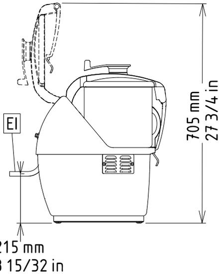
**EI** = Conexión eléctrica (energía)
